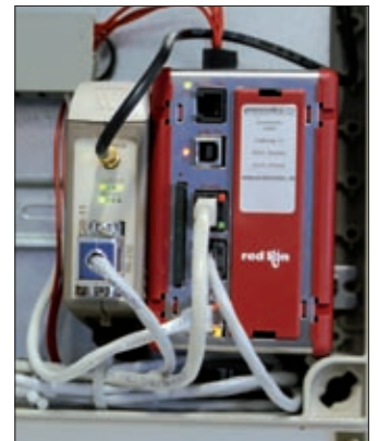
Die Daten-Station kann in der Verteilung auf der Hutschiene montiert werden und erträgt Umgebungstemperaturen von 0 bis 50 Grad Celsius.
